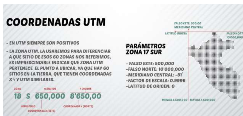
FIGURA 37. ZONA Y COORDENADAS. FUENTE: IGN
